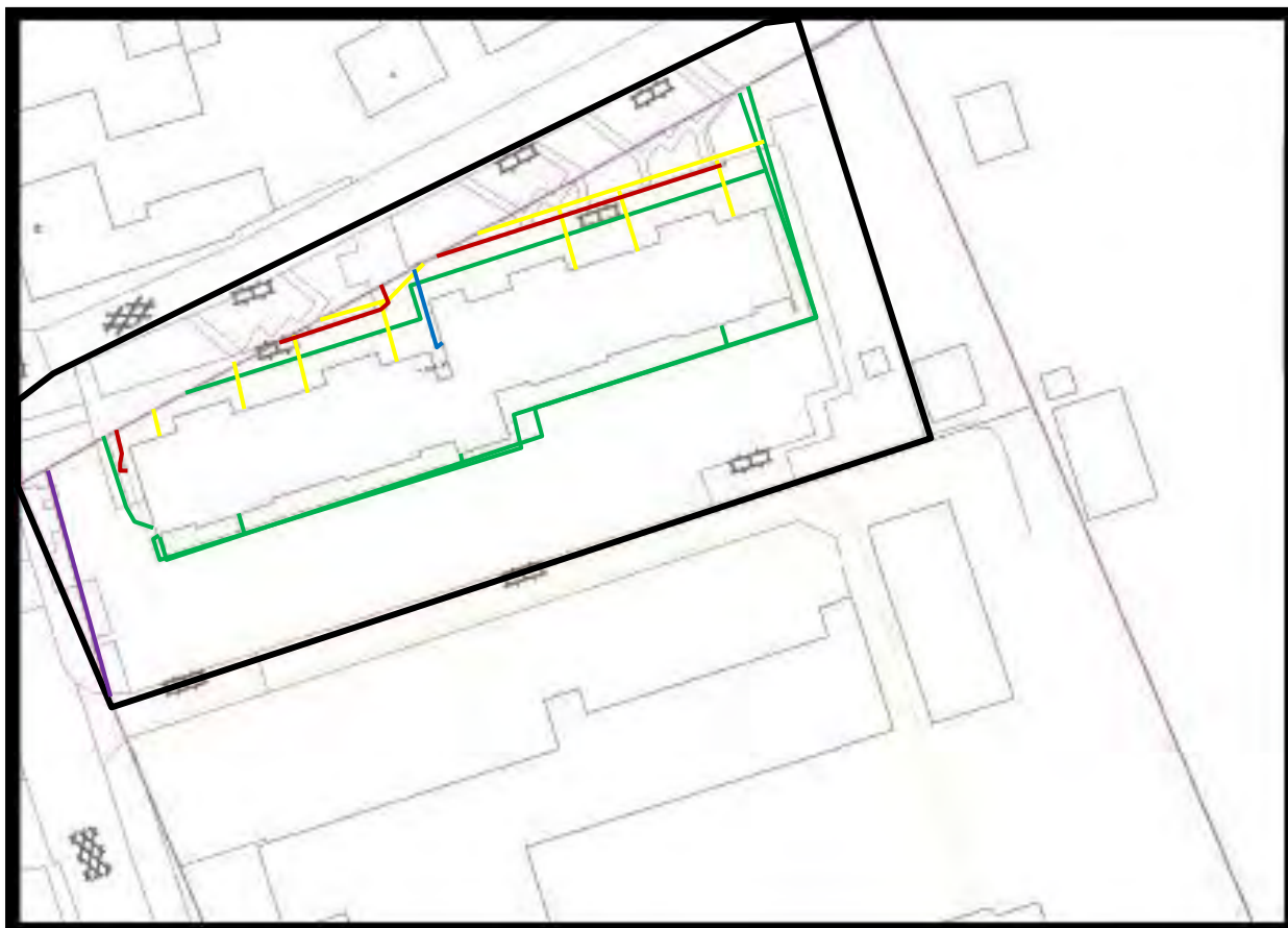
Figuur 6: De aanleg van datatransportkabels (groene lijn), lage druk gasleidingen (gele lijn), waterleidingen (blauwe lijn), rioleringen (paarse en donkerpaarse lijn), laagspanningskabels (donkerrode lijn) in locatie 2 binnen het plangebied (bron: KLIC-melding). De globale begrenzing van locatie 2 is aangegeven door een zwarte lijn.
