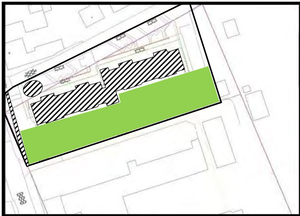
Figuur 8: De gearceerde delen binnen locatie 2 zijn de delen die door de bouw van gebouwen of door de aanleg van rioleringen waarschijnlijk tot onder het archeologische niveau (onder 1,0 m –mv) verstoord zijn. Ook het gebied rondom boring 102 is hier gearceerd weergegeven vanwege het feit dat in deze boring de ondergrond tot minstens 2,0 m –mv verstoord was. In de zones rondom boringen 101, 104 en 105 wordt aangeraden vervolgonderzoek uit te laten voeren.
